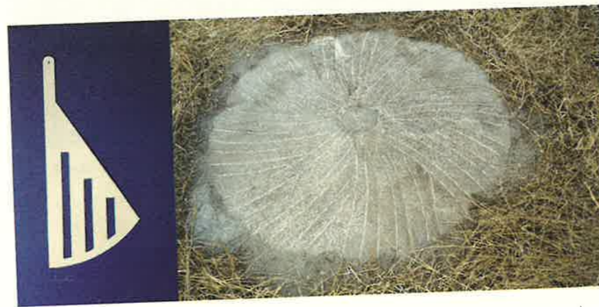
Fig. 12: Plantilla para marcar los rayones y molientes(C.Herrera) y muela con rayones curvos (C.Herrera)
