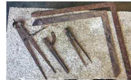
FIG. 34. *Escuadras y compases para la medición y el trazado*
