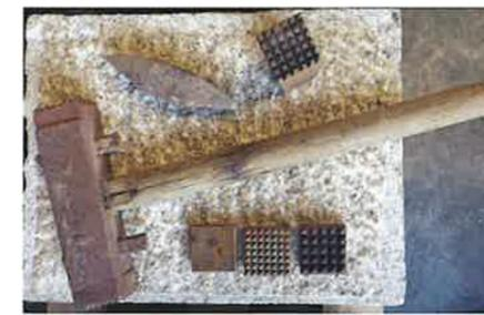
FIG. 35. *Buarda, diferentes cabezas de buarda y piqueta para labra de las caras de sillería*
